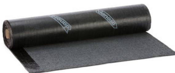
Lámina bituminosa de superficie autoprottegida tipo LBM-40/G-FV (APP -15 °C). Está compuesta por una armadura de fieltro de fibra de vidrio, recubierta por ambas caras con un mástico de betún modificado con plastómeros, acabada en su cara externa en gránulos de pizarra de color gris (negro), como material de protección. En su cara interna, como material antiadherente, incorpora un film plástico de terminación.
