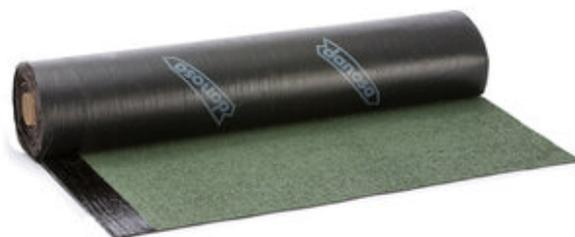
GLASDAN® 40/GP ERF ELAST es una lámina bituminosa de superficie autoprottegida tipo LBM(SBS)-40/G-FV. Está compuesta por una armadura de fieltro de fibra de vidrio, recubierta por ambas caras con un mástico de betún modificado con elastómeros (SBS) y acabada en su cara externa en pizarra de color a elegir como material de protección. En su cara interna, como material antiadherente, incorpora un film plástico de terminación.
